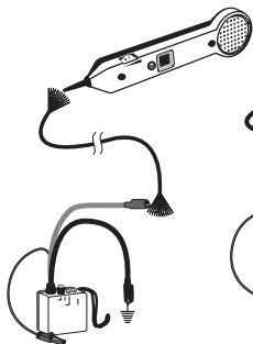
Figura 4a. Rastreamento de cabos
