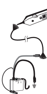
Figura 4a. Rastreo de cables
