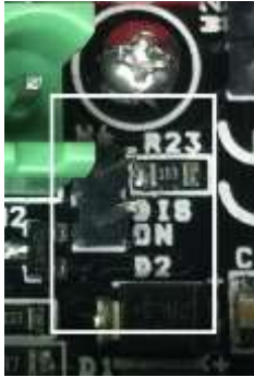
Colocar el puente en DIS ON
