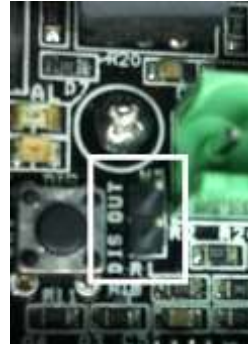
Con el cable suministrado conecte la salida OUT DIS (colector abierto negativo) para transmitir señalización.
