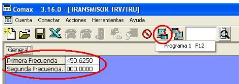
Figura 5. Comandos Leer/Programar frecuencias en el Comax
