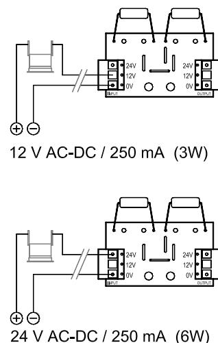
Afin de maintenir un fonctionnement optimal dans des milieux externes à basses températures et risque de condensation, **chaque colonne doit être équipée d'un chauffage à faisceau et d'un thermostat.** Ex.: Une tour avec 4 faisceaux exigera 4 chauffages et 1 thermostat. Barrières et chauffages doivent fonctionner sur des sources d'alimentation séparées, à moins que ceux-ci soient installés dans chaque colonne.
