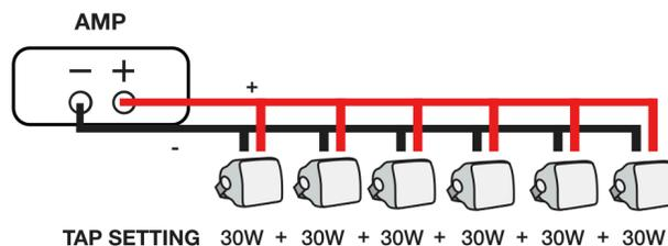
Se tiene que tener cuidado con la combinación de las potencias en las bocinas, no se debe sobre pasar el máximo nivel de seguridad del amplificador.
