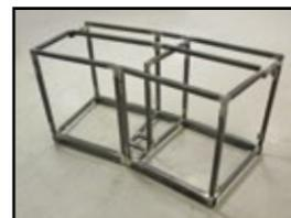
Estructura soldada y de suelo listo para la capa del pintura en polvo
